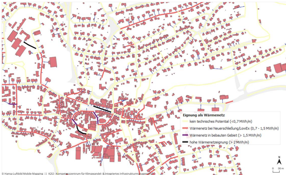
Abb. 11: Wärmeliniendichte (MWh/m) und korrelierende geeignete Wärmenetztypen
