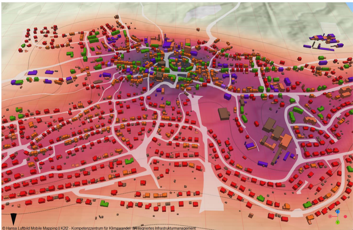
Abb. 8: Die „Heatmap“ als analytisches Instrument zur Analyse der räumlichen Wärmebedarfsmuster
